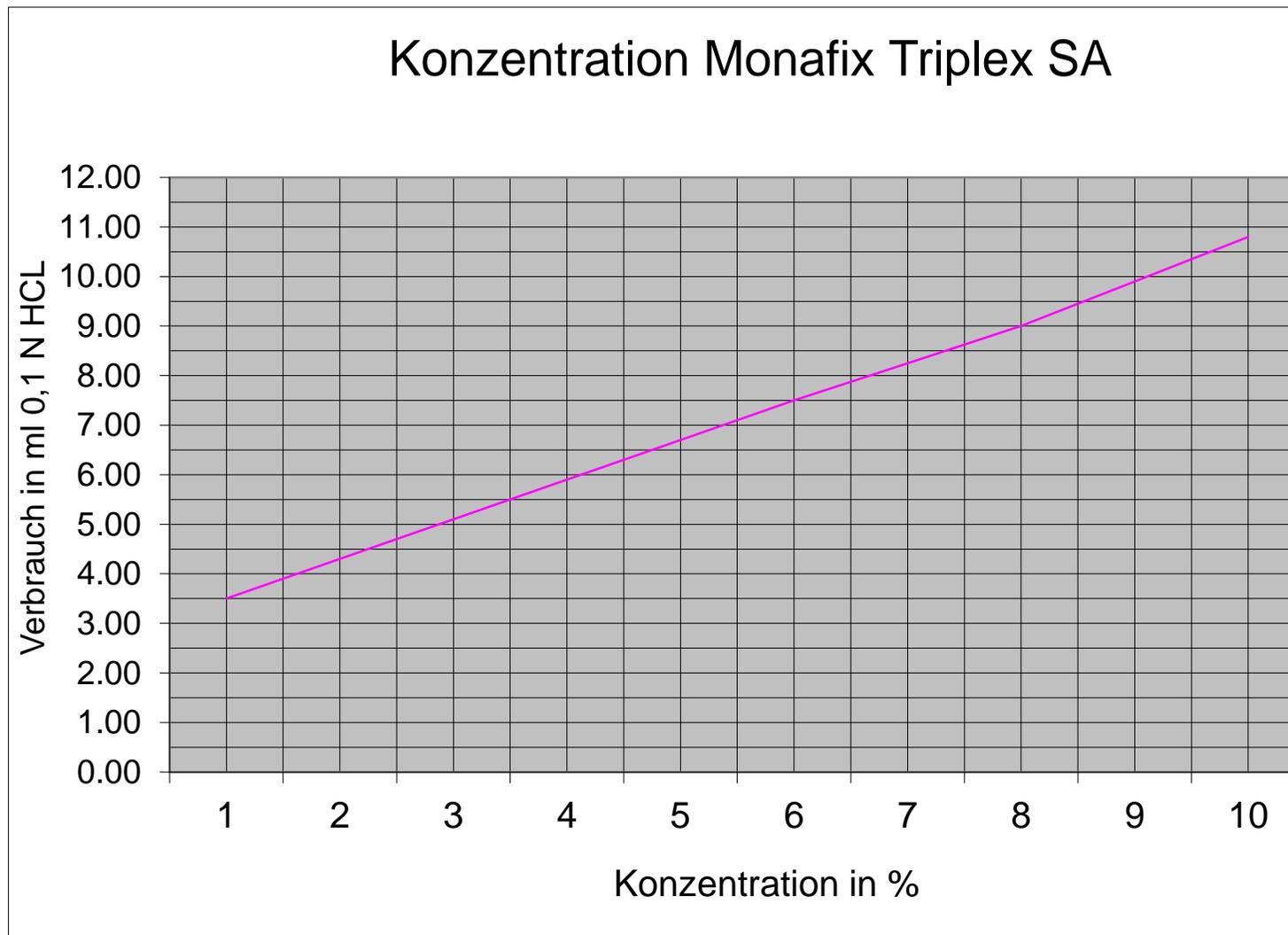
Ajouter 2 à 3 gouttes de solution de méthylorange à 50 ml de liquide et titrer avec 0.1N HCL jusqu'au changement de couleur (vers le rouge). La consommation en ml d'HCL est reportée sur l'axe Y et la concentration en STRUB Monafix Triplex SA est lue sur l'axe X. La concentration en STRUB Monafix Triplex SA est ensuite affichée sur l'axe X.
