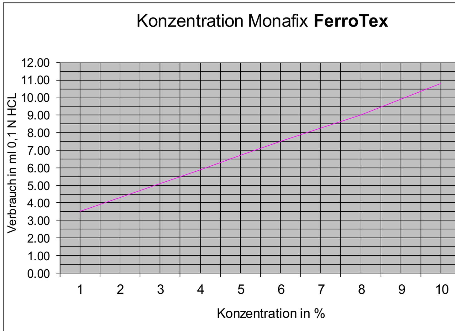
50 ml Flüssigkeit werden mit 0.5 ml Bromphenolblau Indikator-Lösung versetzt und mit 0.1N HCL bis Farbumschlag (auf grau-grün) titriert. Der Verbrauch an ml HCL wird auf der Y- Achse aufgetragen und die Konzentration an **MONAFIX Ferrotex** auf der X- Achse abgelesen.
